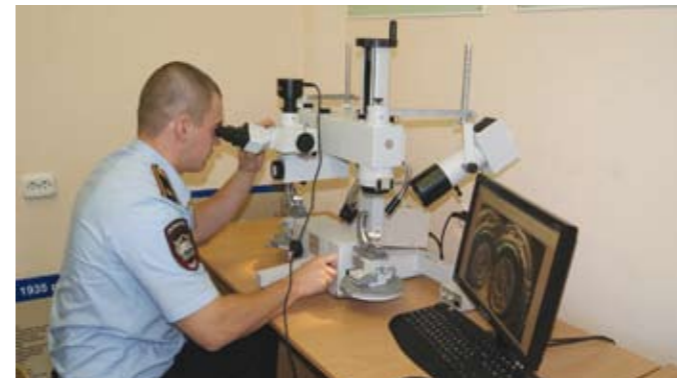
Рис. 1. Сравнительное исследование следов стрелкового огнестрельного оружия на стреляных гильзах (микроскоп МСК-3-1 совмещен с компьютером).
